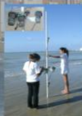
Fig. 4 - Anemômetros (Térmo anemometer Instrutherm TAD-500)
