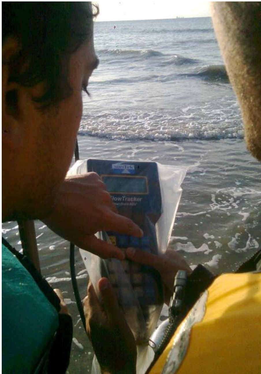
Figura 11 - Medição de altura de onda na Praia do Náutico.
