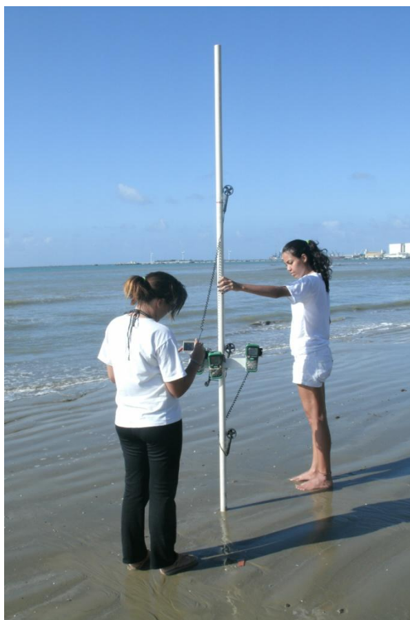
Figura 9 - Anemômetros (Thermo anemometer instrutherm TAD-500).
